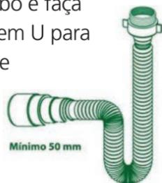
4º Verifique o diâmetro do ponto de esgoto e encaixe o terminal luneta no diâmetro correspondente.
