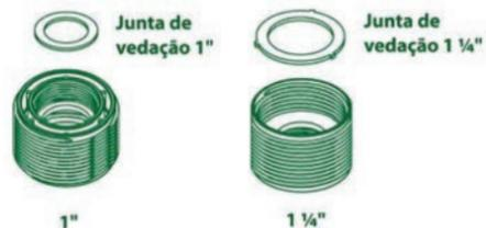
2º Para fazer a ligação: Em válvulas para pias e lavatórios 1" (7/8) e tanques (1.¼), instale o adaptador roscável na válvula e, depois, rosqueie a sobreporca no adaptador roscável. Em válvulas para pia americana (1.½), rosqueie a sobreporca diretamente na válvula;
