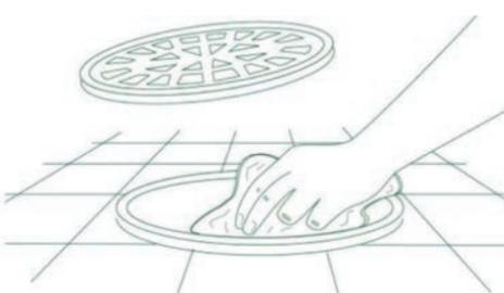
3º Encaixe o anti-inseto no porta-grelha sob pressão, para ficar bem preso ao diâmetro interno do porta grelha;
