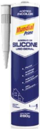
**Adesivo de Silicone:** adesivo vedante, que polimeriza em contato com o ar, transformando-se em uma massa similar à borracha. Adere facilmente em materiais como: azulejos, vidros, metais, cerâmicas, mármore, granitos, plásticos, tecidos e couros.
