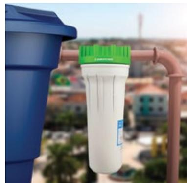
**Filtro Big 10:** filtro com elemento filtrante de 10", para retenção de partículas, elemento lavável, vazão de até 4.200l/h.
