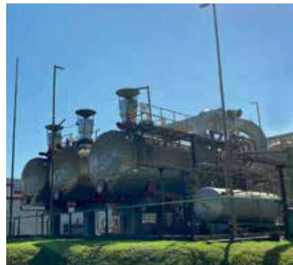
ADERE tem o recuperador de solventes, que otimiza os insumos e evita emissão de gases no ambiente.
