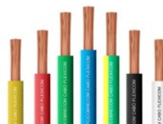
material é indicado para instalações internas fixas, industriais, comerciais e residenciais de luz e força. É formado por fios de cobre nu, eletrolítico, têmpera mole, encordoamento classes 4 e 5 (flexíveis), isolado com Policloreto de Vinila (PVC), tipo PVC/A para 70°C, antichama (BWF-B).
